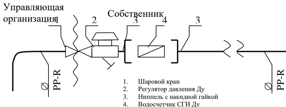
Исполнитель несет ответственность за надлежащее состояние и работоспособность систем горячего и холодного водоснабжения согласно нижеуказанной схеме до волнистой линии слева (включая шаровой кран).
