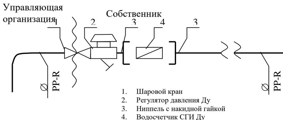
Исполнитель несет ответственность за надлежащее состояние и работоспособность систем горячего и холодного водоснабжения согласно нижеуказанной схеме до волнистой линии слева (включая шаровой кран).
